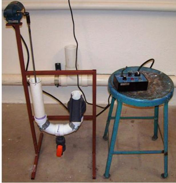
**Figure 24. Smaller U-Shaped Laboratory-Scale Jig.**
